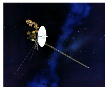
Εικόνα 4.2: Διαστημικό σκάφος Voyager με εμφανές το κοντάρι (boom)
