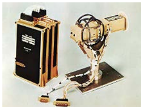
Εικόνα 4.1: Χαρακτηριστικό μαγνητόμετρο που χρησιμοποιήθηκε στα σκάφη Pioneer 10 και 11
