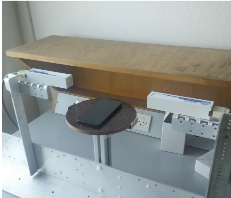
Εικόνα 4.24: Πειραματική διάταξη μετρήσεων μαγνητικού πεδίου ενός κινητού ως δοκιμαστικό εξοπλισμό
