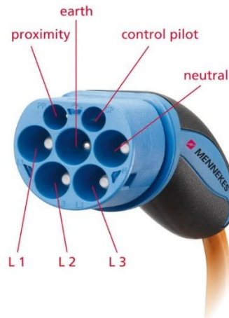
Εικόνα 1.1.7 Βύσμα VDE-AR-E 2623-2-2
