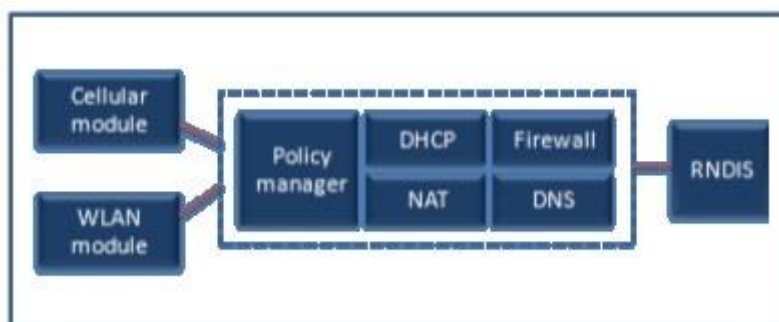
Εικόνα 3.2.1.2 Αρχιτεκτονική USB dongle
