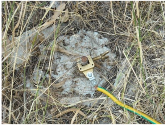
Εικόνα 3.9 Ράβδος γείωσης εντός βελτιωτικού υλικού υπό κρουστική καταπόνηση.
