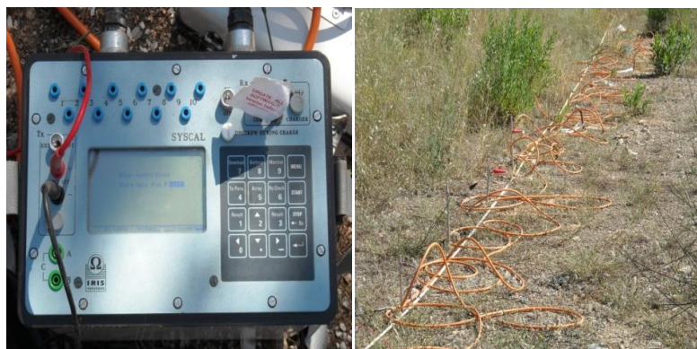
Εικόνα 3.2: Συσκευή μέτρησης SYSCAL Pro Switch-48 (αριστερά) και βοηθητικά ηλεκτρόδια με τα καλώδια μέτρησης [61].
