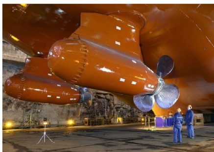
Σχήμα 8: Η σειρά Azipod της ABB, από αριστερά προς τα δεξιά: Azipod CO, Azipod VI, Azipod XO. [9]
