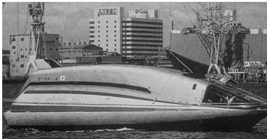
Σχήμα 13: Το πειραματικό πλοιάριο Yamato 1 με ηλεκτρομαγνητική πρόωση. [13]
