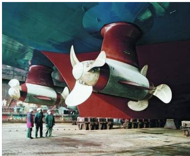
Σχήμα 10: Δύο προωστήρες Siemens-Schottel (SSP) εγκατεστημένοι σε πλοίο.
