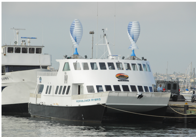
Σχήμα 37: Το επιβατικό πλοίο Hornblower Hybrid με ανεμογεννήτριες κάθετου άξονα και φωτοβολταϊκά πάνελς. [31]
