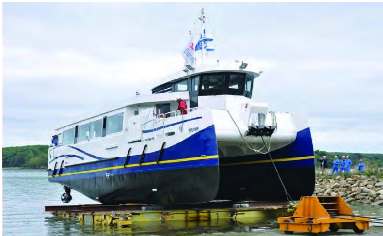
Σχήμα 12: Το κινούμενο από υπερπυκνωτές επιβατηγό Ar Vag Tredan. [5]
