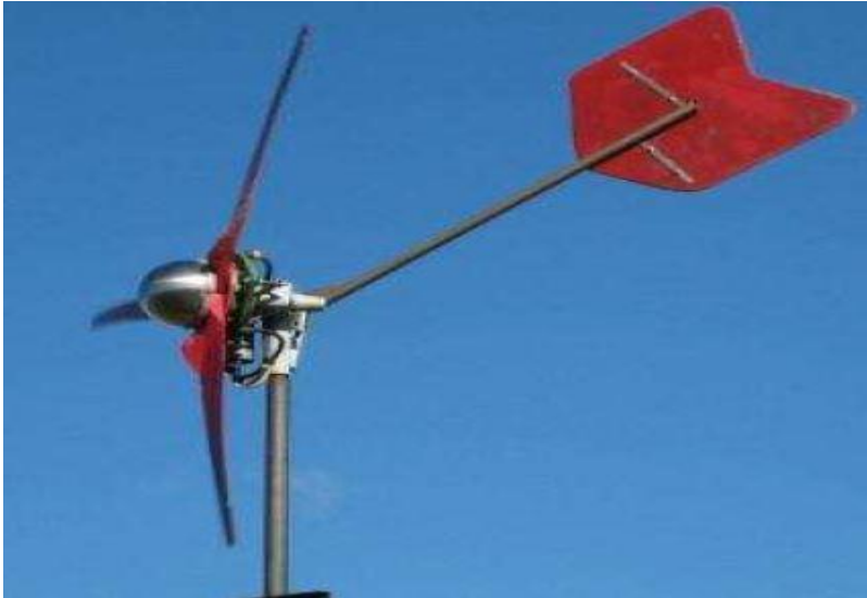
Σχήμα 1.10: Ανύψωση της ουράς και επιβράδυνση της ταχύτητας περιστροφής του δρομέα της ανεμογεννήτριας.
