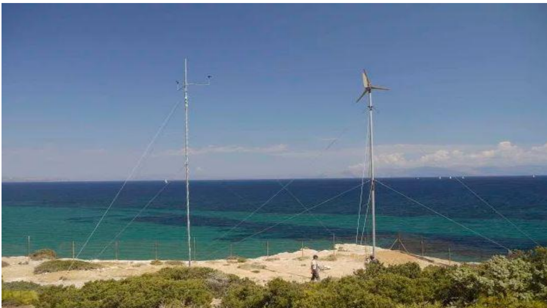
Σχήμα 7.4: Πύργος ανεμογεννήτριας και μετεωρολογικός ιστός στο πεδίο δοκιμών στη Ραφήνα.
