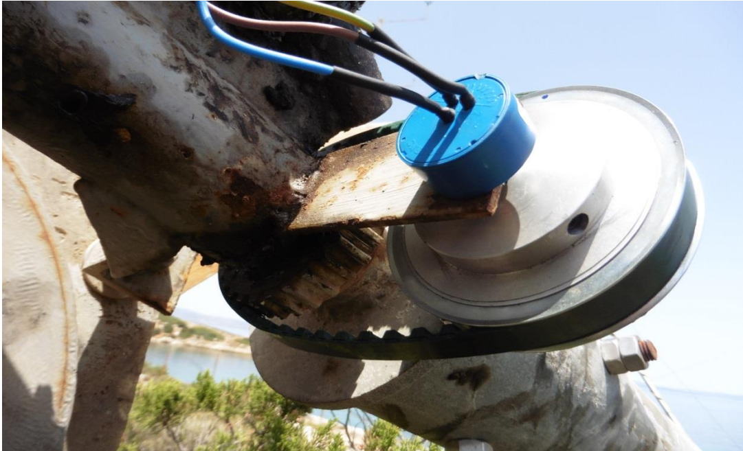
Σχήμα 7.1: Αισθητήρας μέτρησης γωνίας Yaw στο πεδίο δοκιμών.
