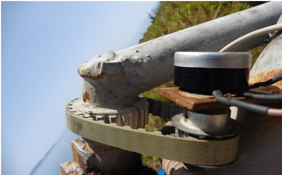
Σχήμα 7.2: Αισθητήρας μέτρησης γωνίας Furling στο πεδίο δοκιμών.
