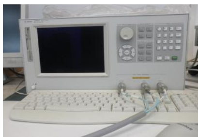
Εικόνα 8: Η γέφυρα υψηλών συχνοτήτων Agilent 4287ARF Meter
