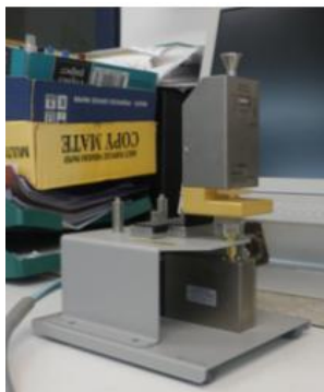
Εικόνα 9: Το κελί διηλεκτρικών μετρήσεων Agilent 16453A
