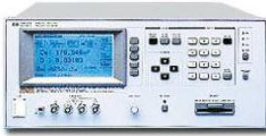
Εικόνα 6: Η γέφυρα χαμηλών συχνοτήτων HP 4283A Precision
