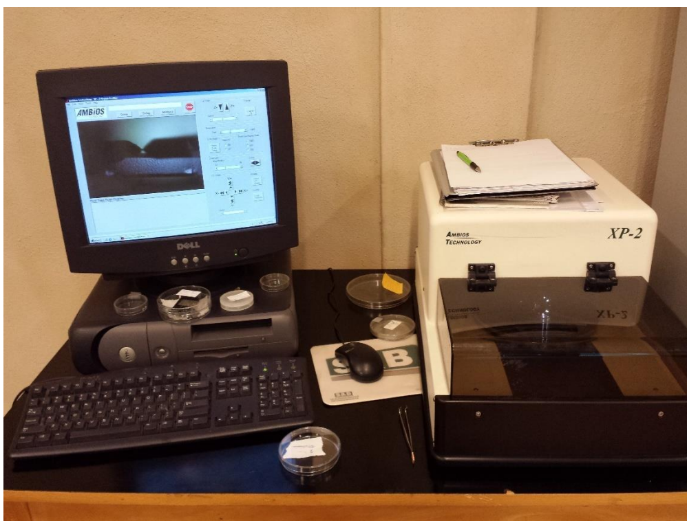
Εικόνα 3.16: Όργανο μέτρησης του προφίλ επιφανειών (Profilometer)
