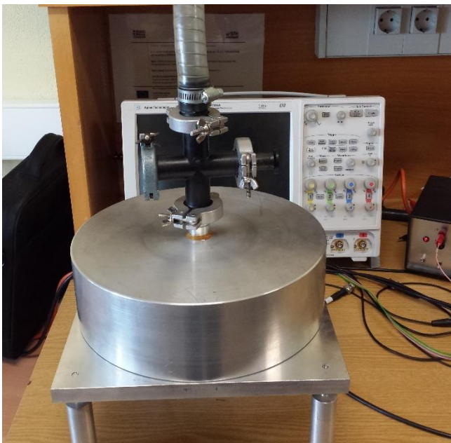
Εικόνα 4.12: Διάταξη μέτρησης σε συνθήκες κενού
