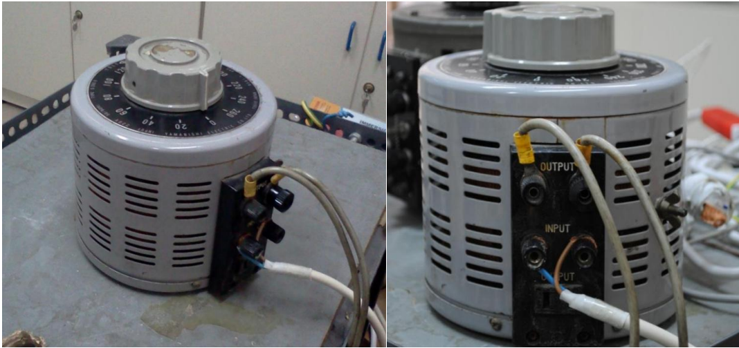
Σχήμα 3.1-1: Αυτομετασχηματιστής ενδιάμεσης λήψης (Variac)
