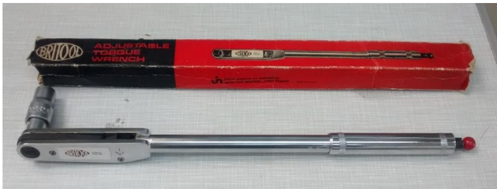
Σχήμα 3.9-1: Ροπόκλειδο για την ρύθμιση της ροπής σύσφιξης
