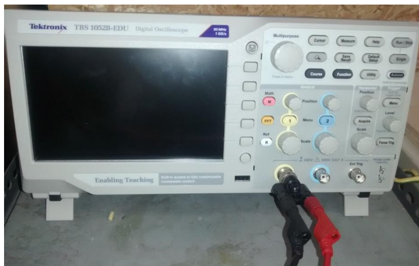
Σχήμα 3.8-1: Ψηφιακός παλμογράφος, χρησιμοποιήθηκε για την μέτρηση της εμφανιζόμενης τάσης στον σύνδεσμο
