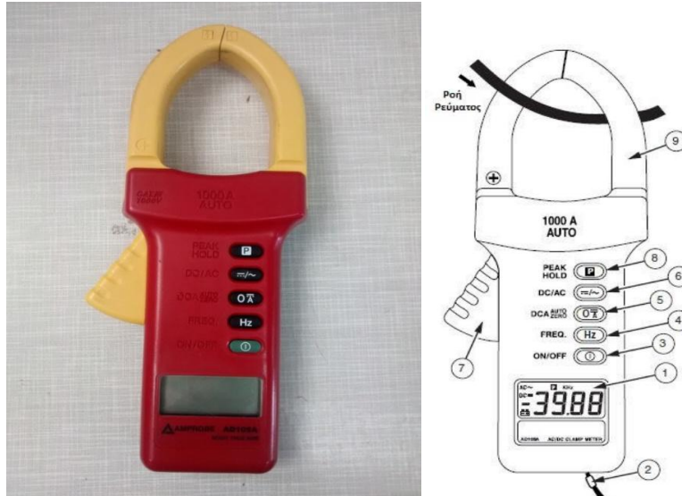
Σχήμα 3.7-1: Αμπεροτσιμπίδα (επαγωγικό αμπερόμετρο) που χρησιμοποιήθηκε για την μέτρηση του ρεύματος στους αγωγούς
