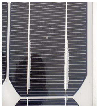
Εικόνα 3.9 : Αποκόλληση της επικάλυψης.
