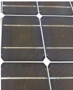
Εικόνα 3.8 : Αλλοίωση στο χρώμα της επικάλυψης EVA.
