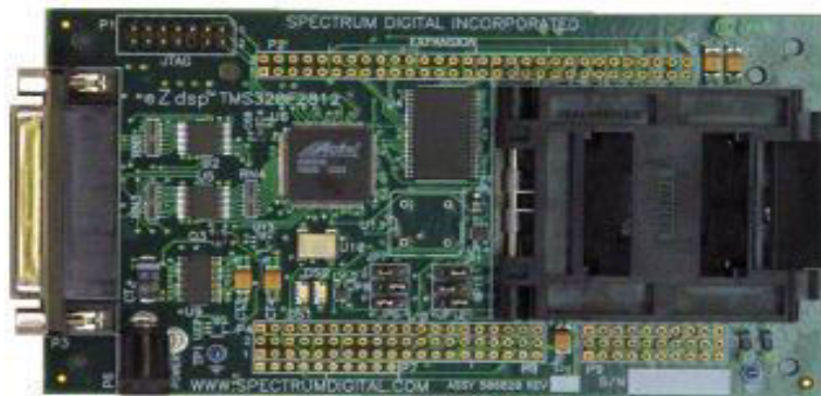
Σχήμα 6.2.1: Ψηφιακός επεξεργαστής σήματος TMS320F2812 και πλατφόρμα eZdsp F2812.
