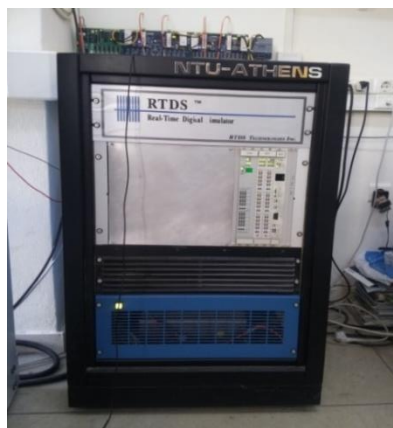
Εικόνα 3.1 Προσομοιωτής RTDS του εργαστηρίου
