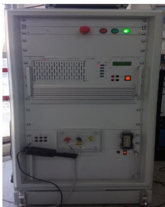
Εικόνα 4.1 Ενισχυτής ισχύος του εργαστηρίου Συστημάτων Ηλεκτρικής Ενέργειας
