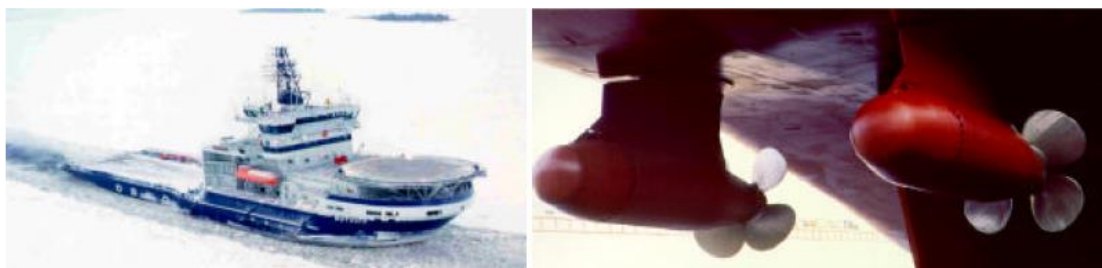
Σχήμα 1.2: “M/S Botnica”, Παγοθραυστικό που χρησιμεύει ως σκάφος εφοδιασμού την θερινή περίοδο, εξοπλισμένο με αζιμουθιακούς προωστήρες (Azipod propulsion). [4]
