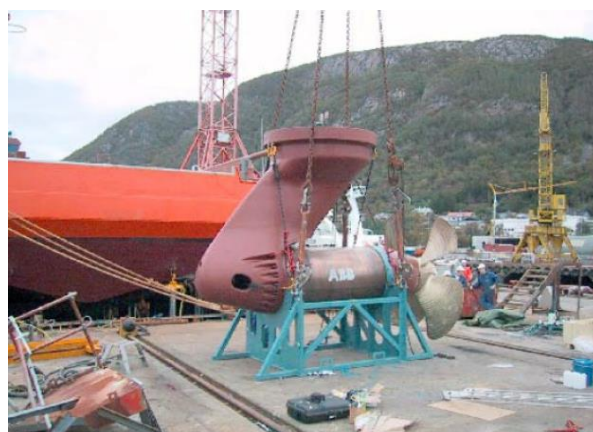
Σχήμα 1.7: Προωστήρας Azipod έτοιμος για τοποθέτηση σε ναυπηγείο της Sovikens Verft [4]
