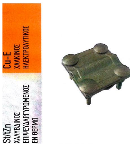
Σχήμα 2-16 Διμεταλλικός σύνδεσμος αγωγών τριών πλακιδίων με ενδιάμεσο ανοξείδωτο πλακίδιο για αποφυγή ηλεκτροχημικής διάβρωσης [16]
