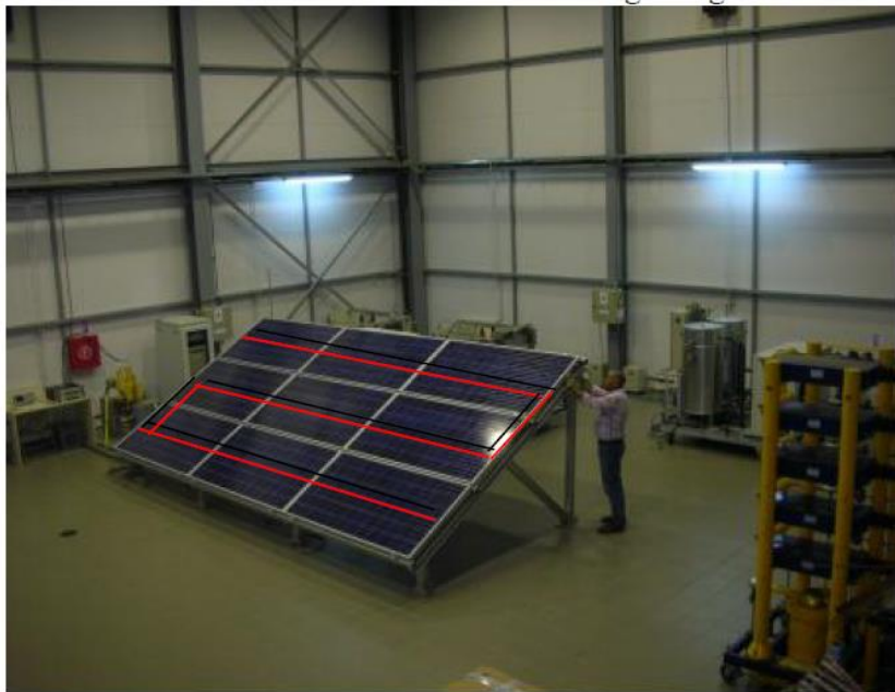
Σχήμα 4-7 Τα φωτοβολταϊκά πάνελ που δοκιμάστηκαν στο εργαστήριο και ο σχηματισμός βρόχου του DC καλωδίου (κόκκινο (+) και μαύρο (-)) [31]
