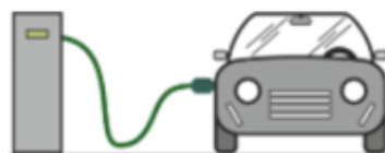
Σχήμα 4.7: Σύνδεση ηλεκτρικού οχήματος τύπου C
