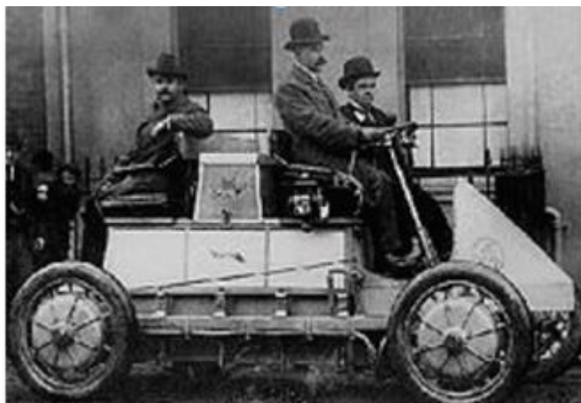
Σχήμα 1.1: To Lohner - Porscher M9te hybrid. Ένα από τα πρώτα αξιόλογα υβριδικά βενζινοκίνητα – ηλεκτροκίνητα.
