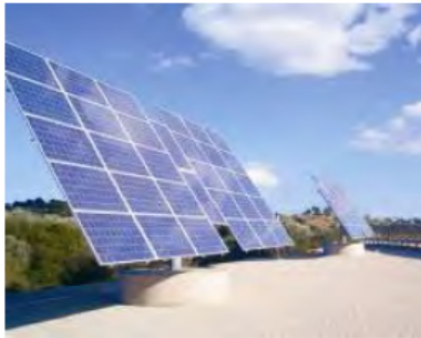
Παράδειγματα διαξονικών ηλιοστατών
