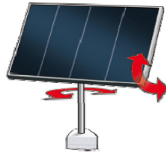
Παράδειγματα διαξονικών ηλιοστατών
