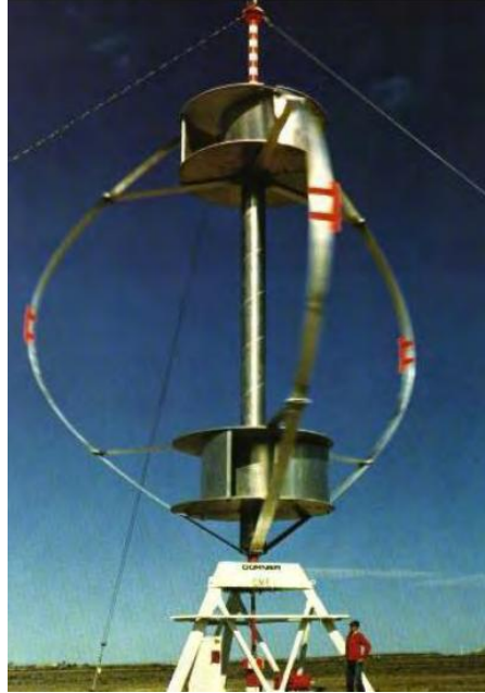
Σχήμα 1.12: Ανεμογεννήτρια κατακορύφου άξονα
