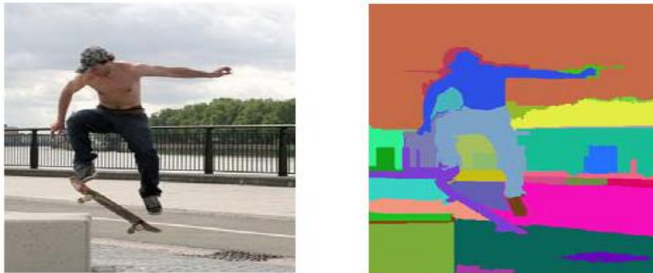
Εικόνα 16: Παράδειγμα κατάτμησης βασισμένης σε γράφο. Αριστερά φαίνεται η εικόνα εισόδου και δεξιά το αποτέλεσμα της κατάτμησης βασισμένο στην μέθοδο MST [61].
