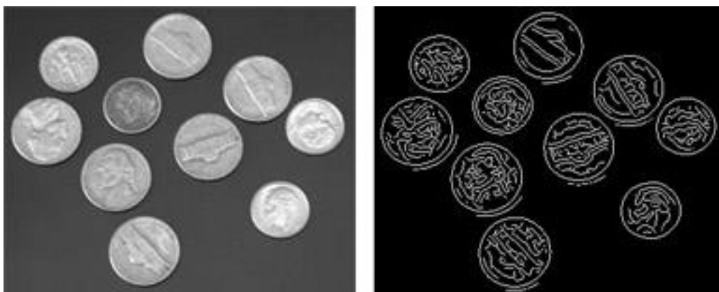
Εικόνα 9: Παράδειγμα της τεχνικής ανίχνευσης ακμών σε εικόνα νομισμάτων. Αριστερά φαίνεται η αρχική εικόνα και δεξιά οι ακμές της χρησιμοποιώντας τη μέθοδο του Canny [39].
