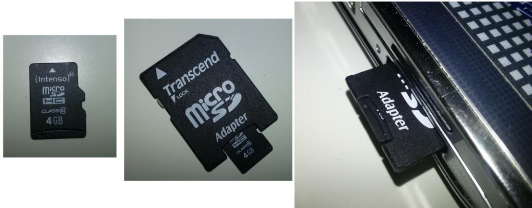
Εικόνα 70 (από αριστερά προς τα δεξιά): Η κάρτα micro SD, ο προσαρμογέας (adapter) για τον προσωπικό υπολογιστή και η τοποθέτησή τους στην αντίστοιχη θύρα.
