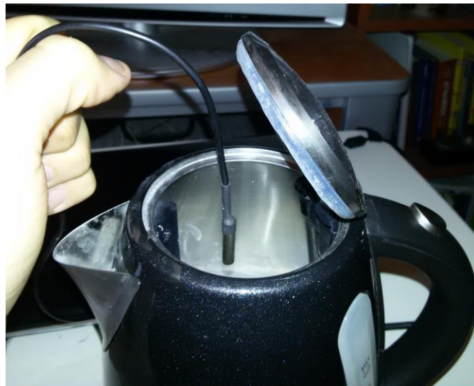
Εικόνα 64: Η βύθιση του αισθητηρίου θερμοκρασίας του Arduino στο βραστήρα
