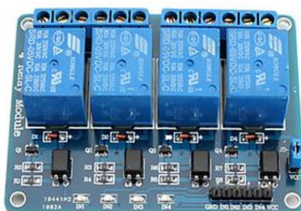
Εικόνα 42-β: Η πλακέτα με τα ρελέ (relay module)
