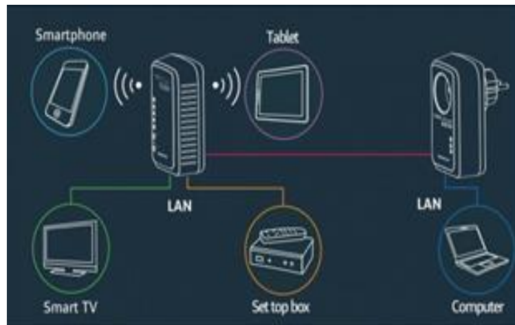
Εικόνα 6: Η δικτύωση με PLC
