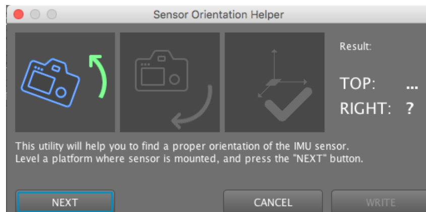
Σχήμα 2.9 Αυτόματη ρύθμιση των αξόνων του αισθητήρα μέσα από το πρόγραμμα της πλακέτας
