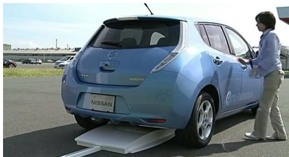
Εικόνα 1.43: Επαγωγική φόρτιση του οχήματος Nissan leaf από πηνία επί του δρόμου (πηγή : https://cleantechnica.com/2015/11/19/nissan-steps-on-inductive-wireless-charging-pedal/ )
