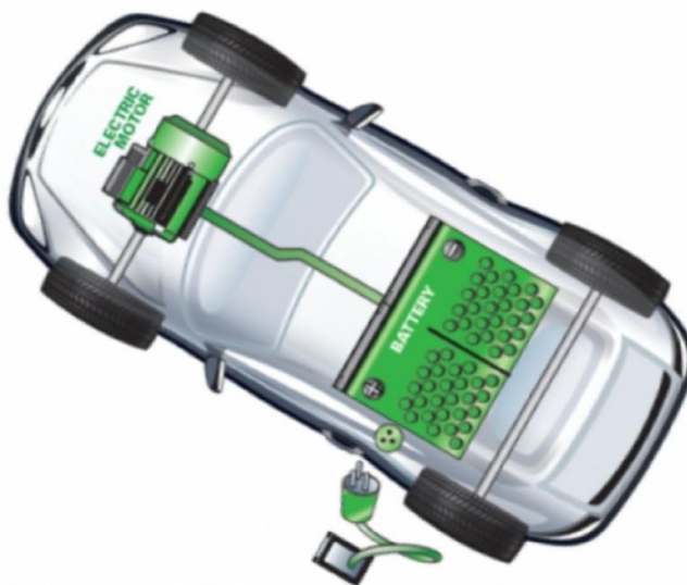
Εικόνα 1.26: Απλή απεικόνιση διάταξης ηλεκτρικού οχήματος με μπαταρία ( BEV ) (πηγή : https://www.asdreports.com/news-1688/supercharged-france-be-key-player-electric-vehicle-battery-production-boom )
