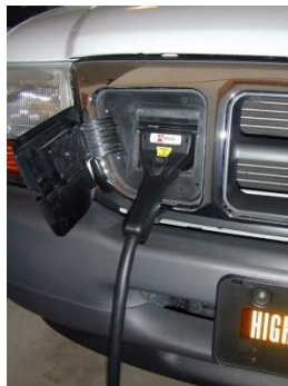
Εικόνα 1.42 : Το ηλεκτροκίνητο όχημα ford ranger ενώ φορτίζει με ένα από τα πρώτα βύσματα –το βύσμα ancon (πηγή : https://en.wikipedia.org/wiki/Ford_Ranger_EV )
