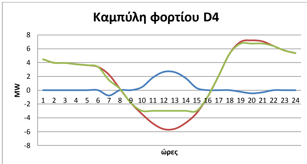
Εικόνα 4.73: Ημερήσια καμπύλη φορτίου με διείδυση 20 MW ισχύος από ΑΠΕ και προσθήκη 1000 ηλεκτρικών οχημάτων – στρατηγική D4.
