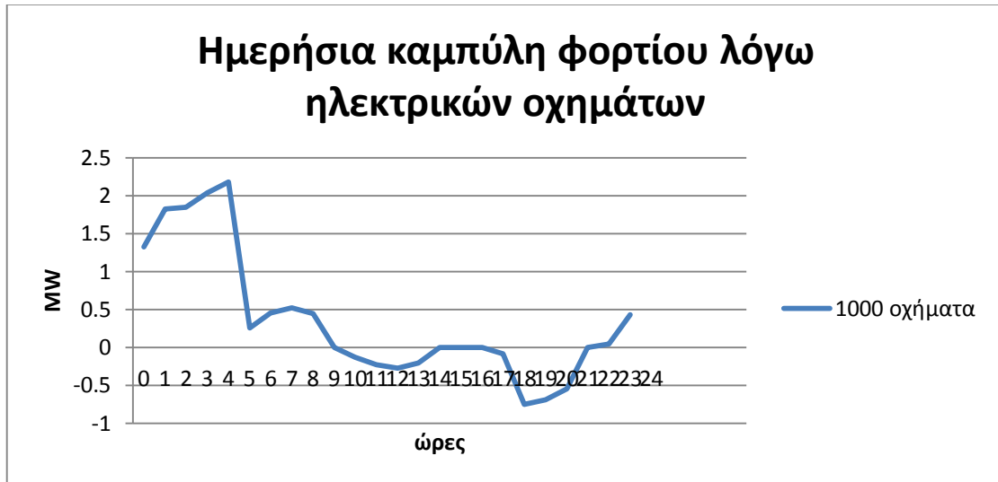
Εικόνα 3.20: Ημερήσια καμπύλη ζήτησης φορτίου στόλου 1000 οχημάτων ,με χρήση της στρατηγικής φόρτισης D και PERC=20%.
