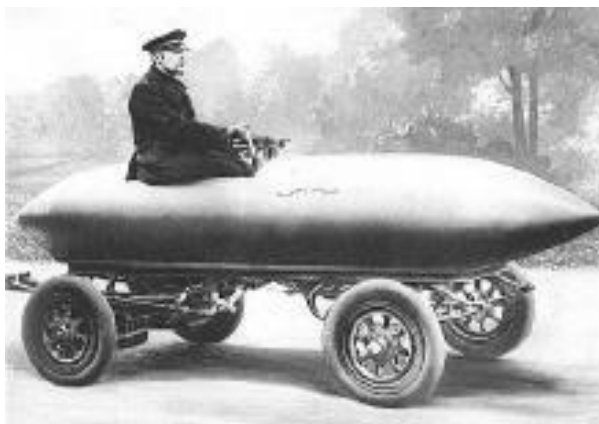
Εικόνα 1.6: Ο μηχανικός Camille Jenatton ,φωτογραφημένος με το ηλεκτρικό του όχημα «La Jamais Contente» -1899 ( πηγή : http://www.grandprixhistory.org/jenatton_bio.htm )
