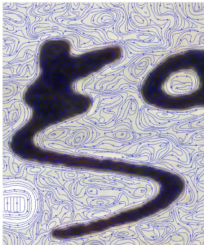
Εικόνα 3.5-32: Η grayscale εικόνα που αντιστοιχεί στο υπολογισθέν πεδίο κλίσεων, όπως υπολογίστηκε με αριθμητική επίλυση κατάλληλα ορισμένου προβλήματος συνοριακών τιμών και όπως περιγράφηκε στην παράγραφο 3.4.
