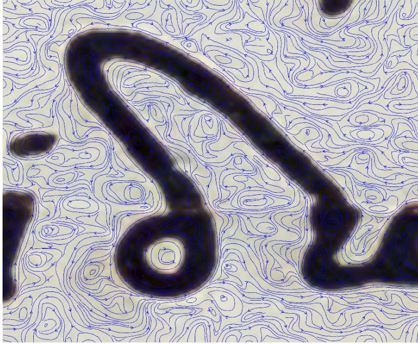
Εικόνα 3.5-5: Αποτύπωση της ροής που επάγει το πεδίο των κλίσεων, το οποίο υπολογίστηκε ως ισοδύναμο των τοπικών χρωματικών μεταβολών της εικόνας σύμφωνα με την LAB αναπαράστασή της.
