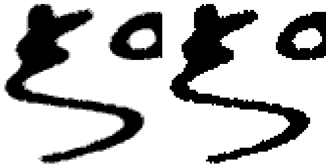
Εικόνα 4-39: Η απεικόνιση της κατάτμησης του ιστογράμματος ως κατάτμηση της grayscale εικόνας (αριστερά) και η μεγιστοποιημένη αντίστοιχη δυαδική κατάτμησης της (δεξιά)
