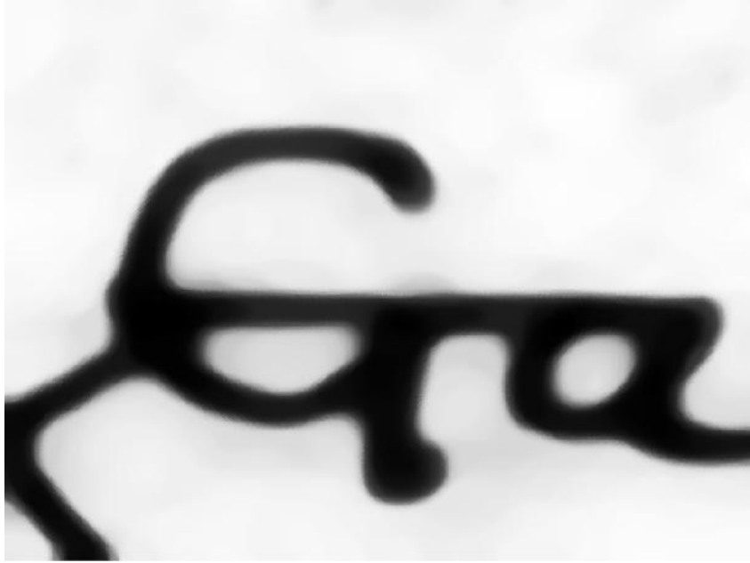
Εικόνα 3.5-3: Η grayscale εικόνα που αντιστοιχεί στο υπολογισθέν πεδίο κλίσεων, όπως υπολογίστηκε με αριθμητική επίλυση κατάλληλα ορισμένου προβλήματος συνοριακών τιμών και όπως περιγράφηκε στην παράγραφο 3.4.
