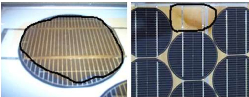
Εικόνα 39 Αποχρωματισμένες φωτοβολταϊκές κυψέλες (LEEE-TISO, 2008; Kaplanis and Kaplani , 2011). [21]
