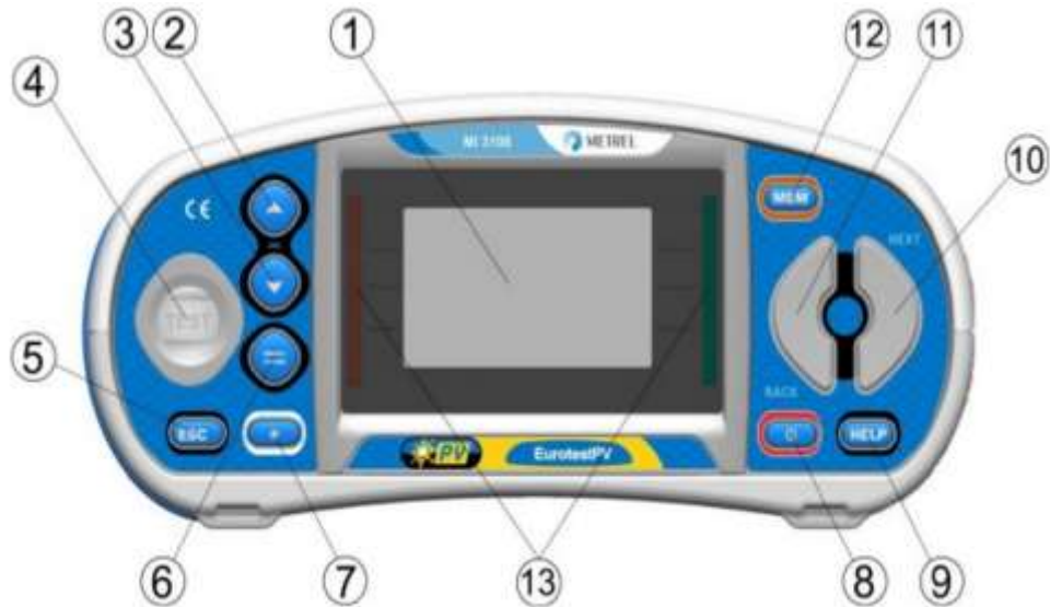
Εικόνα 71 Μπροστινή όψη του οργάνου MI 3108 Eurotest. Τα κουμπιά 1 έως 12 χρησιμεύουν για την περιήγηση στο μενού του οργάνου. [87]
