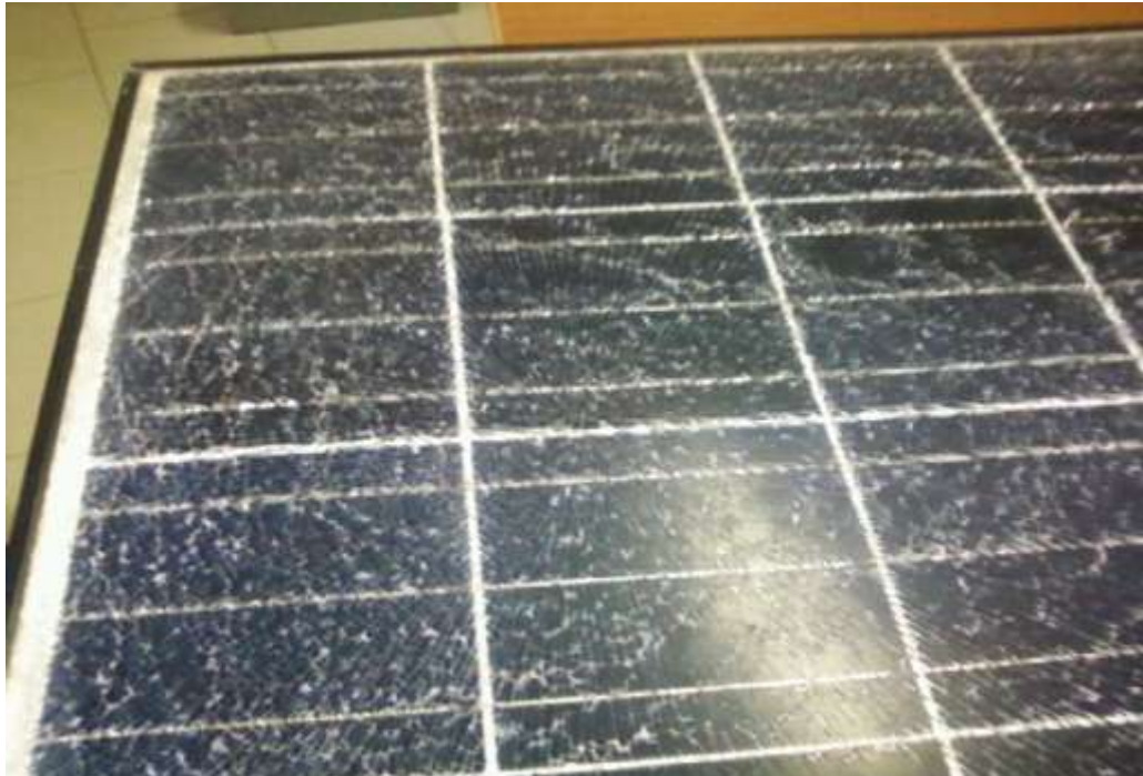
Εικόνα 41 Φωτοβολταϊκή μονάδα με ραγισμένο γυαλί. [21]
