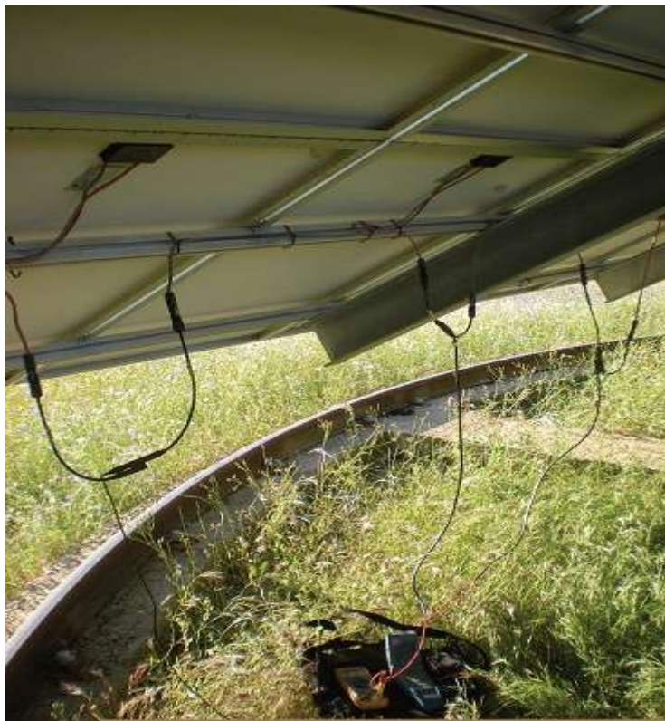
Εικόνα 55 Στην εικόνα αυτή φαίνονται οι “T” συνδέσεις στους πόλους δύο φωτοβολταϊκών πλαισίων προκειμένου να μετρηθεί η τάση λειτουργίας V_{op} τους χωρίς να ανοιχθεί το κουτί σύνδεσης. [60]
