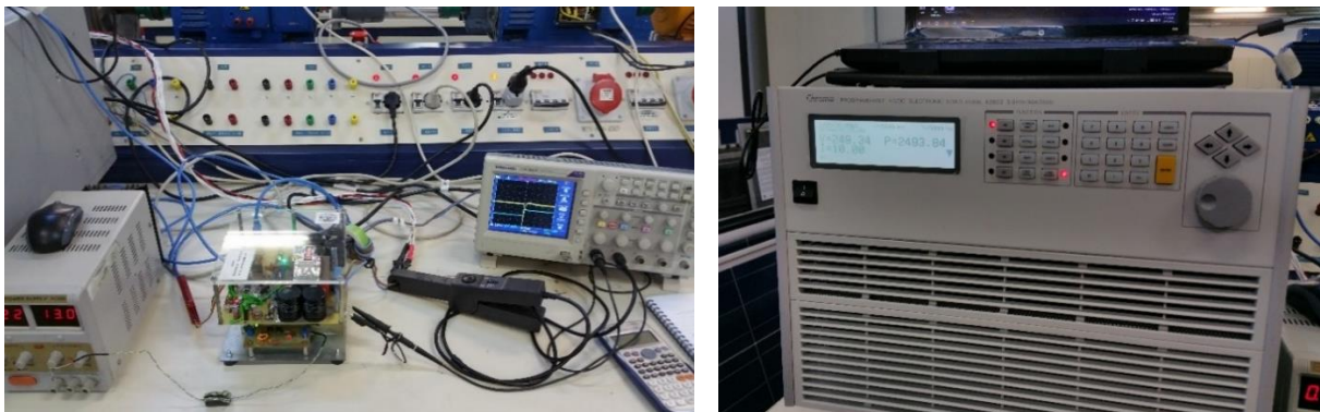
Σχήμα 8.12: Πειραματική διάταξη μέτρησης βηματικής απόκρισης (αριστερά), ηλεκτρονικό φορτίο με ρύθμιση 10A/250V (δεξιά).
