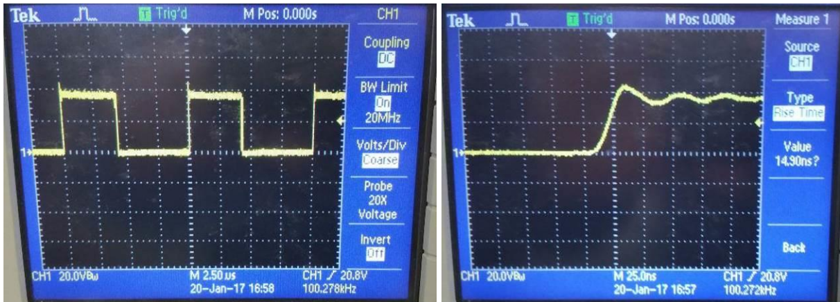
Σχήμα 8.11: Κυματομορφή τάσης διακοπτικών στοιχείων μετατροπέα Buck στη κάθοδο της διόδου (αριστερά) και του χρόνου ανόδου (δεξιά).
