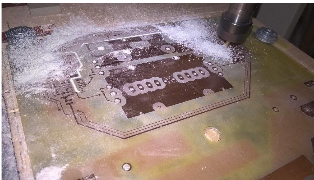
Σχήμα 11.12: Κοπή διάκενων και τρύπημα πλακέτας σταδίου απομόνωσης με χρήση CNC.
