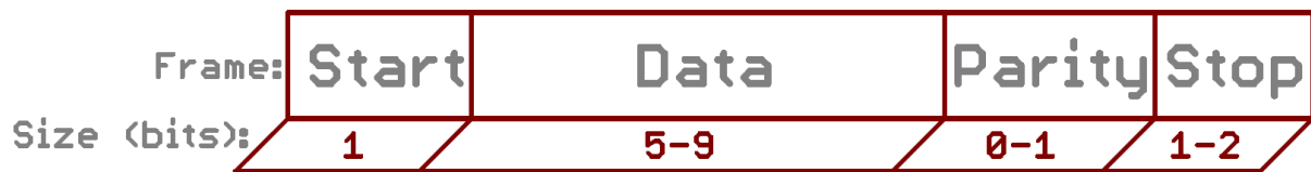
Σχήμα 7.6: Bit συγχρονισμού πακέτου δεδομένων UART ( learn.sparkfun.com/ )
