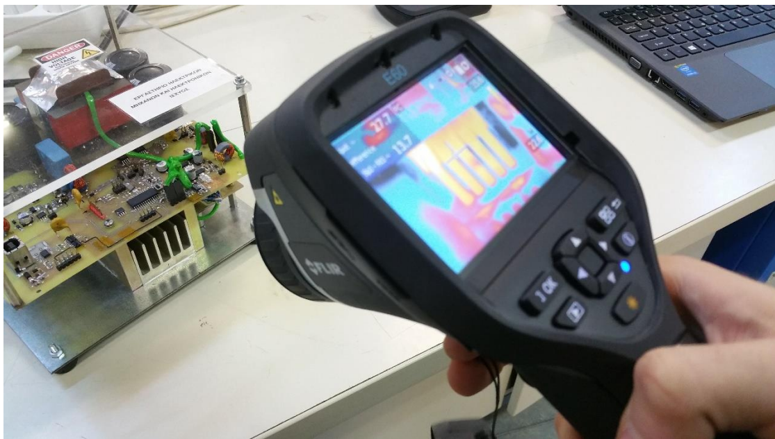
Σχήμα 8.1: Πειραματική διάταξη μέτρησης θερμοκρασιών λειτουργίας με χρήση θερμικής κάμερας.
