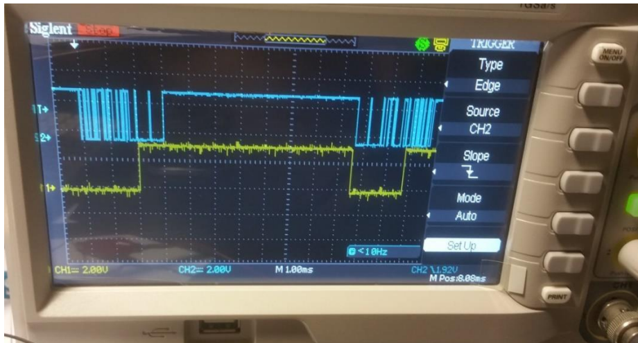
Σχήμα 7.8: Κυματομορφή σήματος επικοινωνίας UART. Με γαλάζιο χρώμα εικονίζεται το κανάλι δεδομένων UART, με κίτρινο χρώμα το σήμα CTS (Clear To Send). Η διακοπή της αποστολής δεδομένων από τον υπολογιστή καθυστερεί επιτρέποντας την αποστολή 2 επιπλέον bytes.
