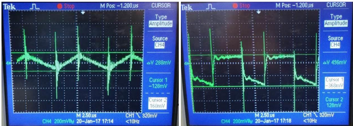
Σχήμα 8.9: Μετρήσεις κυμάτωσης τάσης πυκνωτών εξόδου (αριστερά) και εισόδου (δεξιά).
