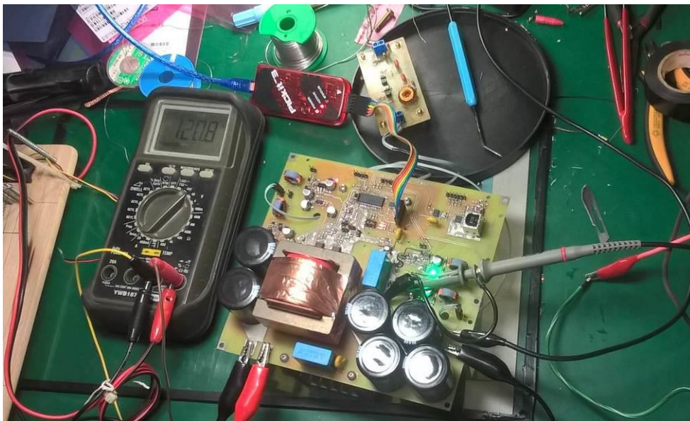
Σχήμα 11.14: Κόλληση κυκλώματος ισχύος και έλεγχος ορθής λειτουργίας.
