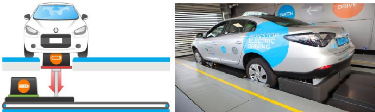
Σχήμα 2.20: Μηχανική φόρτιση οχήματος με εναλλαγή συσσωρευτών σε ειδικούς σταθμούς.
