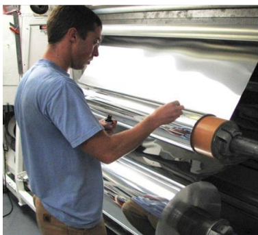
Εικόνα 3.3: Ηλιακά «κεραμίδια» Με εκτύπωση σε ρολό, εύκαμπτων φωτοβολταϊκών μεμβράνης
