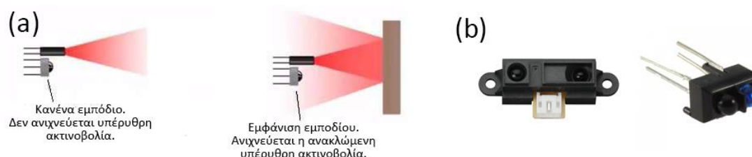
Εικόνα 2.7 – (α) Σχεδιάγραμμα των βασικών αρχών ανίχνευσης απόστασης μέσω οπτικής τεχνολογίας και (β) παραδείγματα εμπορικών ζευγών υπέρυθρου led και φωτοτρανζίστορ. 7, 8, 9
