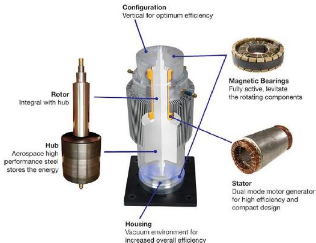
Εικόνα 2.5 – Σχηματική απεικόνιση ενός Flywheel
