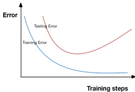
Σχήμα 2.9 Σύμπτωμα υπερπροσαρμογής όπου το δοκιμαστικό λάθος είναι πολύ μεγαλύτερο από το εκπαιδευτικό λάθος
