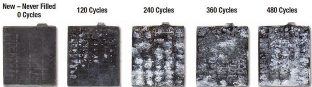
Εικόνα 5. Επίδραση της θειίκωσης σε πλάκα της μπαταρίας ανά κύκλους φόρτισης [6].
