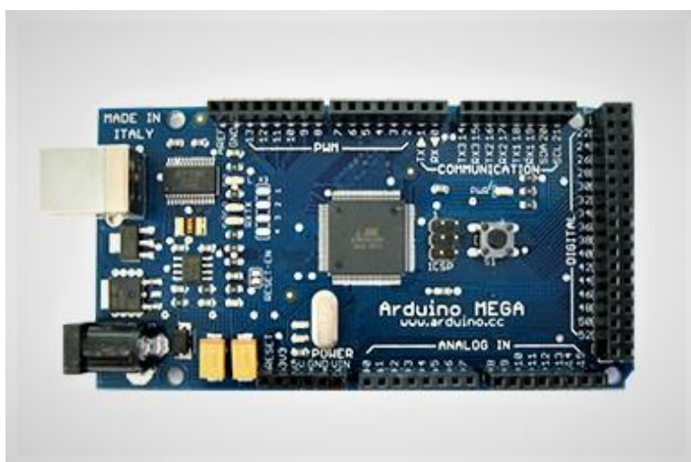
Σχήμα 17. Μητρική πλακέτα του Arduino Mega (Πηγή: https://www.arduino.cc/en/Main/arduinoBoardMega )
