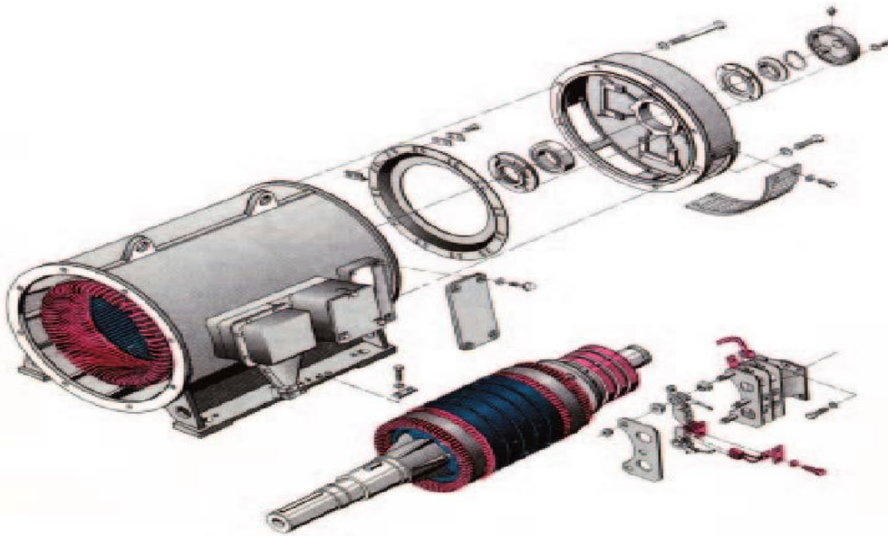
Σχήμα 2. Επαγωγικός κινητήρας με δακτυλιοφόρο δρομέα (Πηγή: http://www.hlektrologia.weebly.com/uploads/6/7/1/5/6715419/p209_284.pdf )
