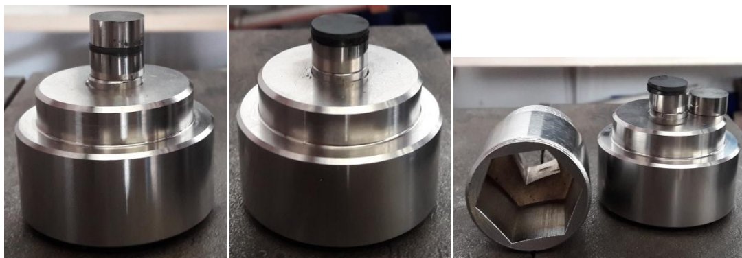
Τελική πελέτα διαμέτρου 1.3 cm, καθώς βγαίνει από τη μήτρα.
