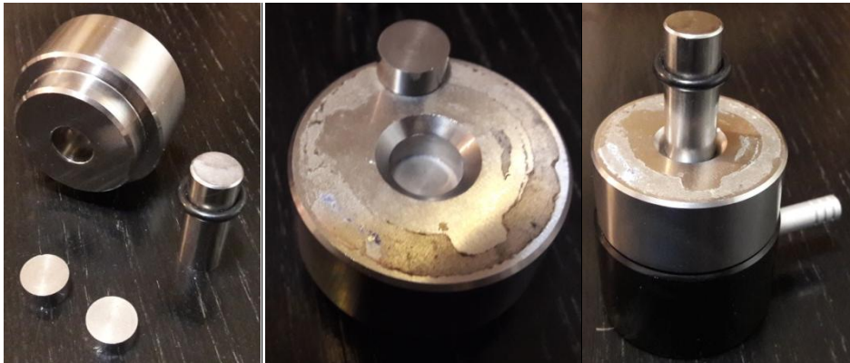
Μήτρα διαμέτρου 1.3 cm και έμβολο συμπίεσης της εταιρίας Specac.
