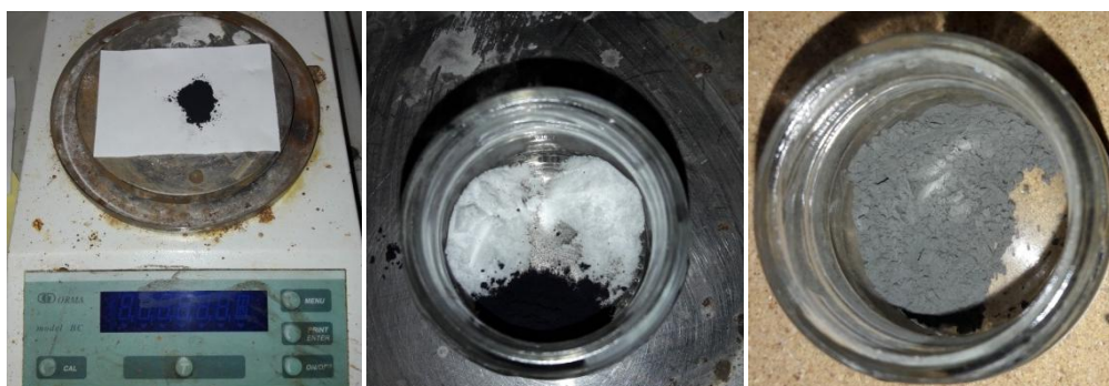
Ζύγιση και ανάμιξη των πρώτων υλών \text{SrCO}_3 , \text{CaCO}_3 και \text{CuO} .
