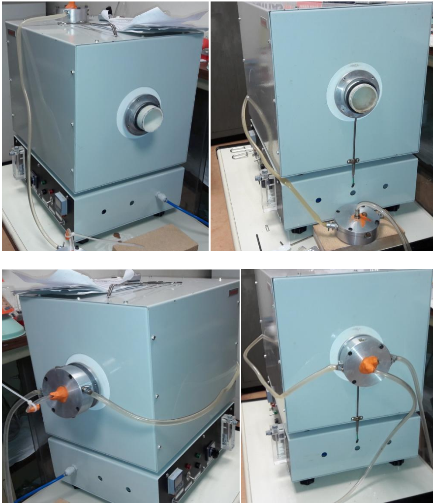
Κατασκευή συστήματος ψύξης του φούρνου.
