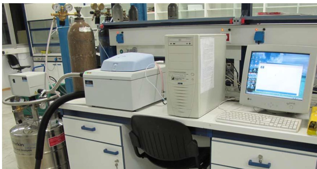
Διαφορική θερμική ανάλυση(DTA). Το όργανο, ο Η/Υ ελέγχου και το σύστημα τροφοδοσίας.
