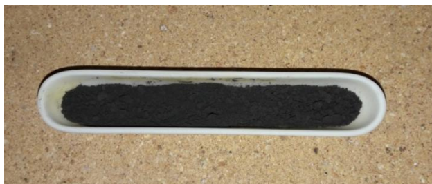
Το μίγμα των \text{SrCO}_3 , \text{CaCO}_3 και \text{CuO} , μετά από την έψησή του για 24h.
