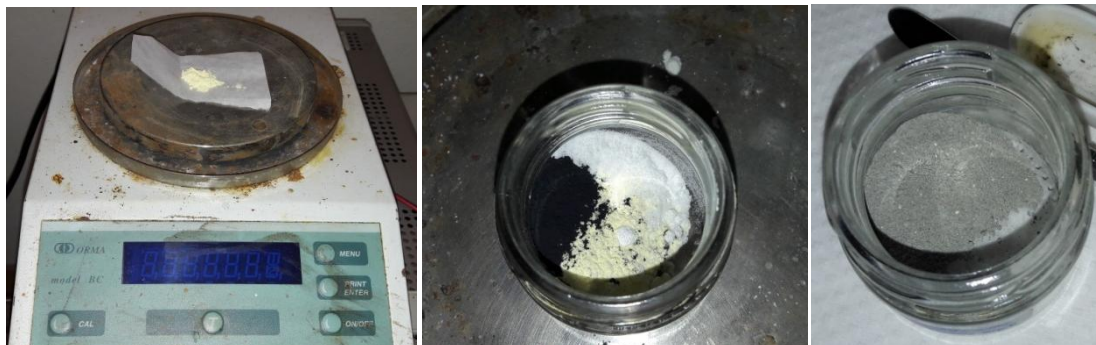
Ζύγιση και ανάμιξη των πρώτων υλών \text{Bi}_2\text{O}_3 , \text{SrCO}_3 , \text{CaCO}_3 και \text{CuO} .
