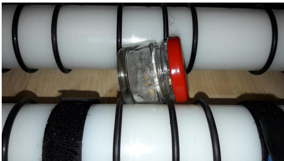
Λειοτριβήση του μίγματος των πρώτων υλών στο σφαιρόμυλο για 15 λεπτά.
