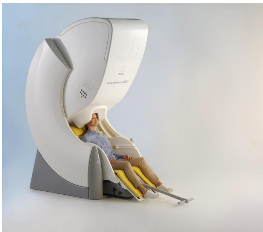
Συσκευή MSI – χρήση SQUID. [7]
