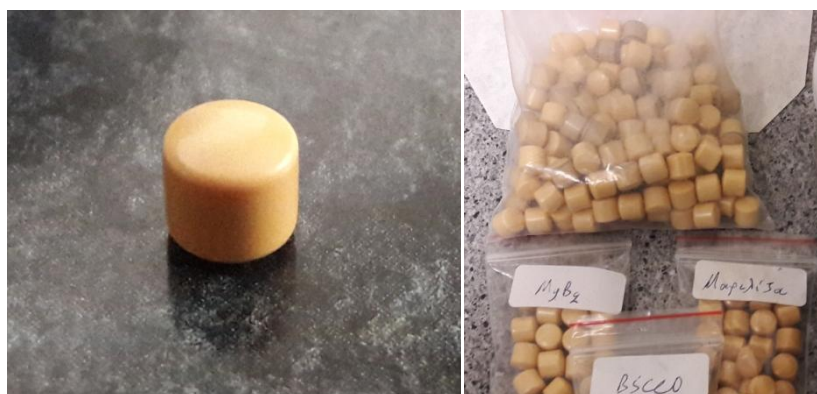
Σφαίρες-κυλινδρίσκοι Ζirkονίας, ( \text{ZrO}_2 ) ως μέσο λειοτρίβησης.
