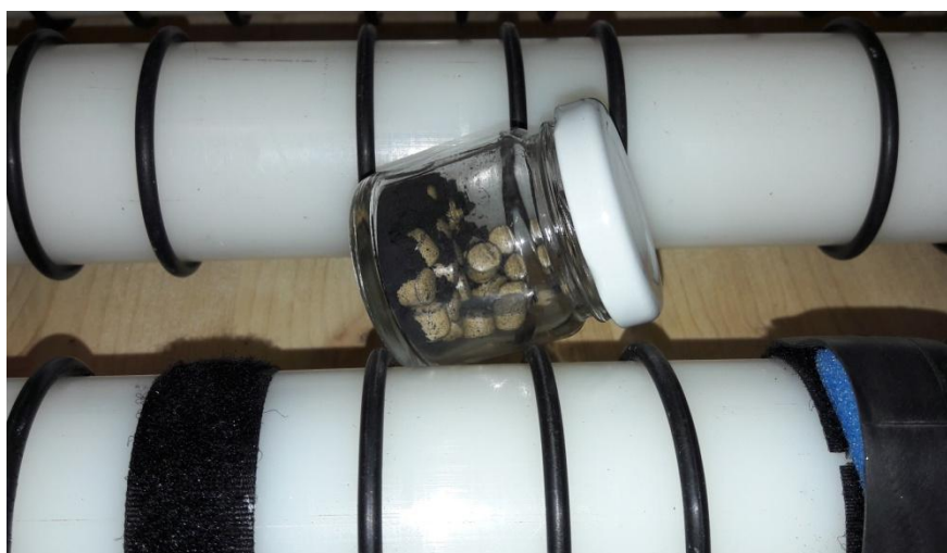
Λειοτρίβηση του μίγματος των \text{Bi}_2\text{O}_3 , \text{SrCO}_3 , \text{CaCO}_3 και \text{CuO} στο σφαιρόμυλο για 15 λεπτά.
