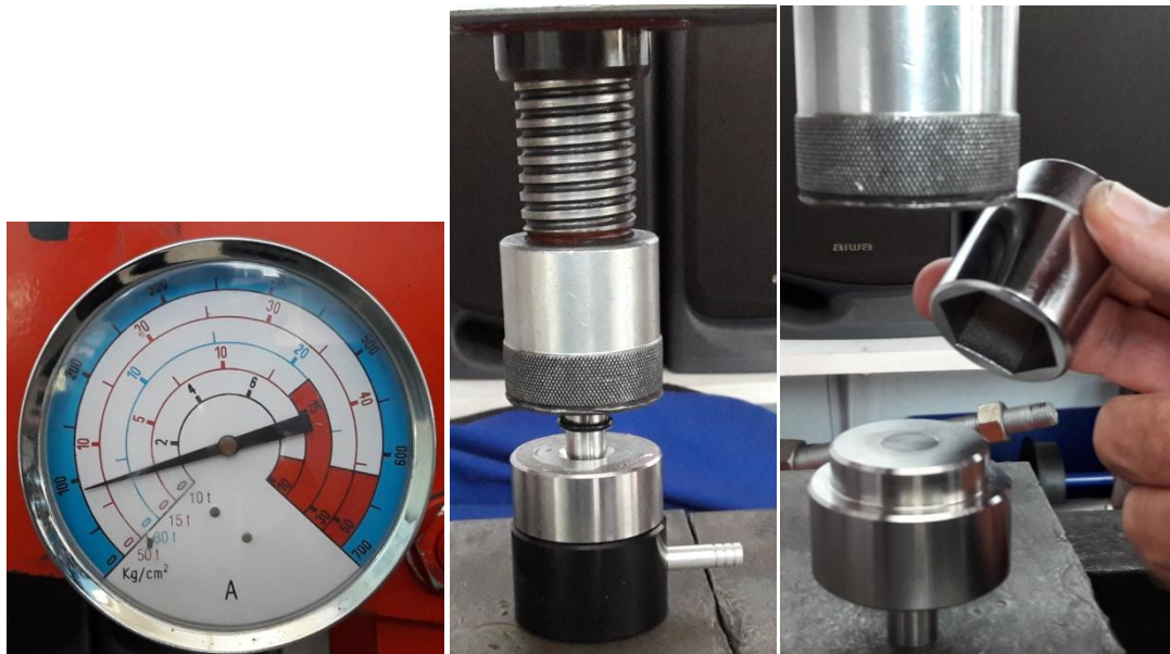
Εφαρμογή πίεσης περίπου 100 \text{ kg/cm}^2 – Συμπίεση στην πρέσα – Ξεκαλούπωμα.
