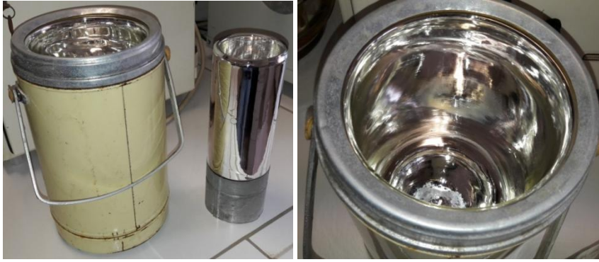
Δοχείο DEWAR, της Isotherm για την εισαγωγή υγρού αζώτου, ως ψυκτικού μέσου.
