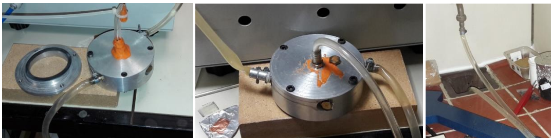
Μεταλλικά πώματα – Μονωτικοί δακτύλιοι – Πλαστικοί σωλήνες ψύξης – Αποχέτευση.
