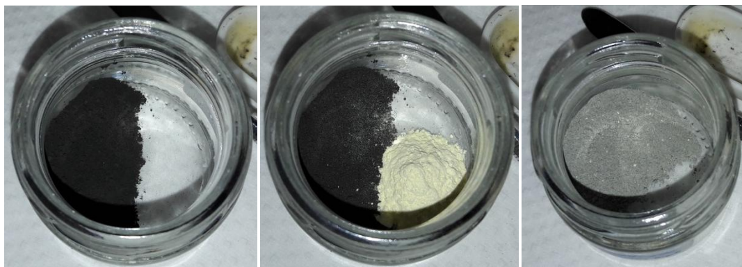
Πρόσθεση της κατάλληλης ποσότητας \text{Bi}_2\text{O}_3 στο μίγμα των \text{SrCO}_3 , \text{CaCO}_3 και \text{CuO} .
