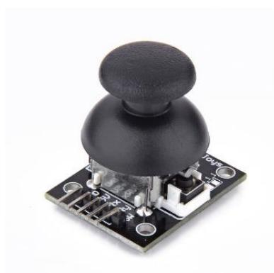
Το Joystick, ως περιφερειακό βοήθημα, επιτρέπει την κίνηση σε δύο διαστάσεις ανάλογα με τη φυσική θέση του Joystick διαβάζεται ως αναλογικό σήμα από το Arduino. Οι τιμές αυτές έχουν εύρος από 0 έως 1023 για κάθε άξονα. Το Arduino έχει τη δυνατότητα να αναγνωρίσει με μεγάλη ακρίβεια τη θέση στην οποία βρίσκεται το joystick.
