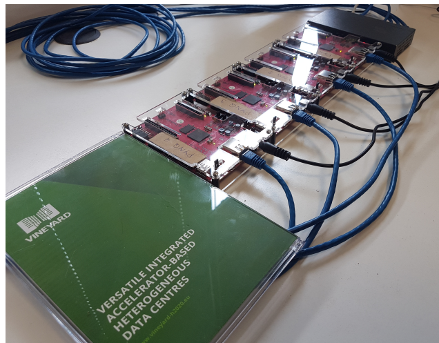
Σχήμα 6.1: Το cluster που στήθηκε στο εργαστήριο με στόχο να δοκιμαστεί σε αυτό η εφαρμογή των αλγορίθμων σε spark. Αποτελείτε απο 4 pynq και ένα switch.
