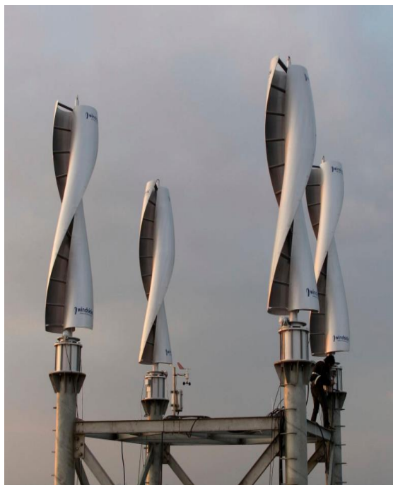
Σχήμα 2.5 Ανεμογεννήτρια κατακόρυφου άξονα τύπου Savonius[9]
