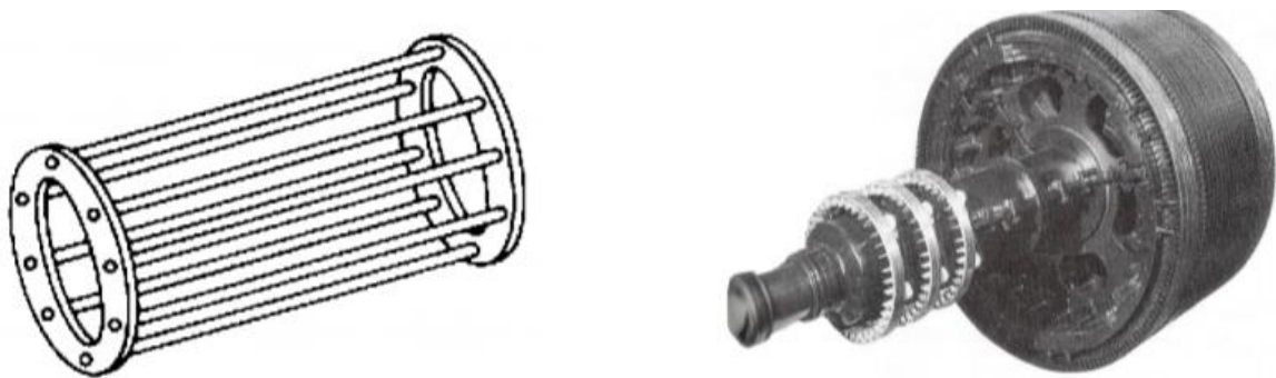
Σχήμα 2.6 Ασύγχρονη μηχανή βραχυκυκλωμένου κλωβού(αριστερά) και δακτυλιοφόρου δρομέα(δεξιά)[10]
