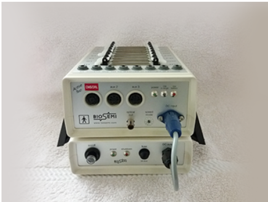
Σχήμα 3.1: Η συσκευή καταγραφής των ΗΕΓ σημάτων Biosemi ActiveTwo.
