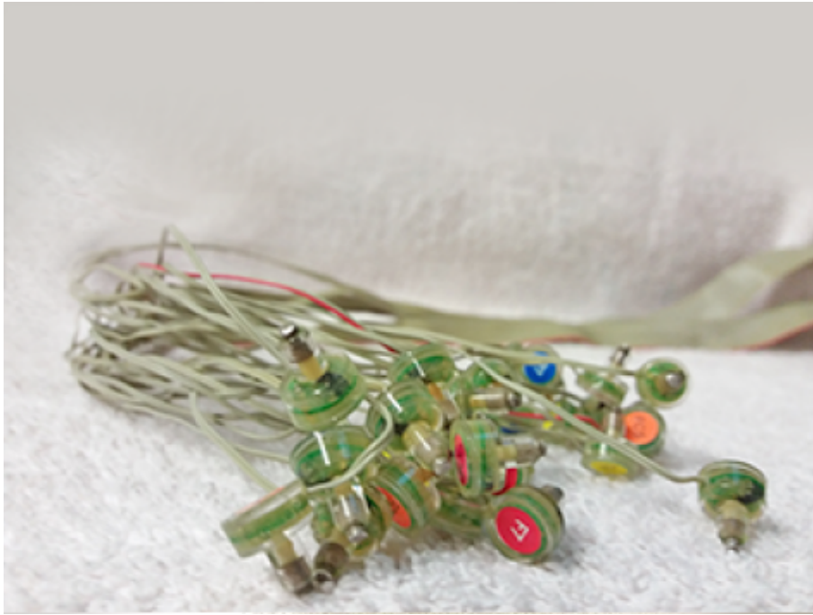
Σχήμα 3.2: Τα ηλεκτρόδια που χρησιμοποιούνται για την καταγραφή των σημάτων.
