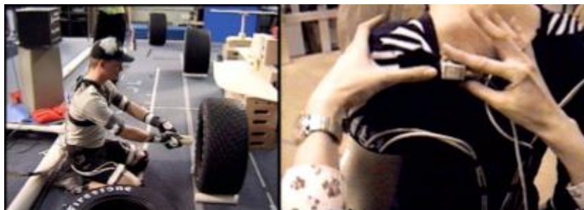
Εικόνα 2.2: Παράδειγμα μαγνητικού συστήματος. Αριστερά: Ηθοποιός που χρησιμοποιεί μαγνητικό κοστούμι mocap. Δεξιά: Μαγνητικός αισθητήρας mocap.
