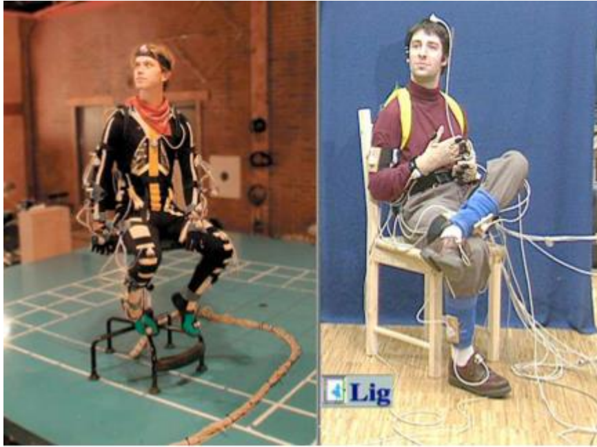
Εικόνα 2.1: Παράδειγμα μηχανικού συστήματος. Αριστερά: Ηθοποιός χρησιμοποιώντας κοστούμι πλήρους μηχανικής κίνησης. Δεξιά: Ηθοποιός χρησιμοποιώντας μόνο μερικούς μηχανικούς αισθητήρες αντί για ένα πλήρες κοστούμι.
