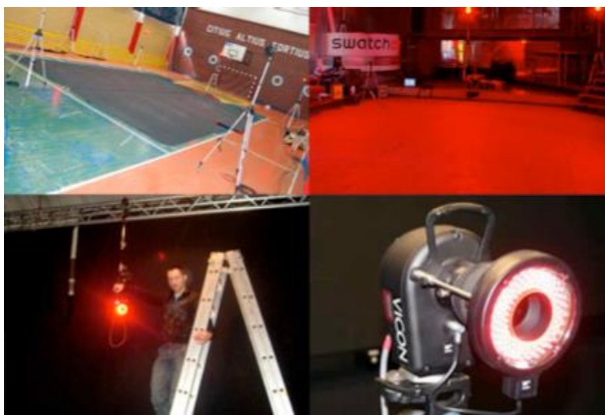
Εικόνα 2.3: Παράδειγμα οπτικού συστήματος. Πάνω αριστερά: Ένα mocap studio. Κάτω δεξιά: Το ίδιο mocap studio κατά τη διάρκεια της καταγραφής κίνησης. Κάτω αριστερά: Κάμερα λήψης κίνησης. Κάτω δεξιά: Κάμερα λήψης κίνησης σε κοντινή απόσταση.
