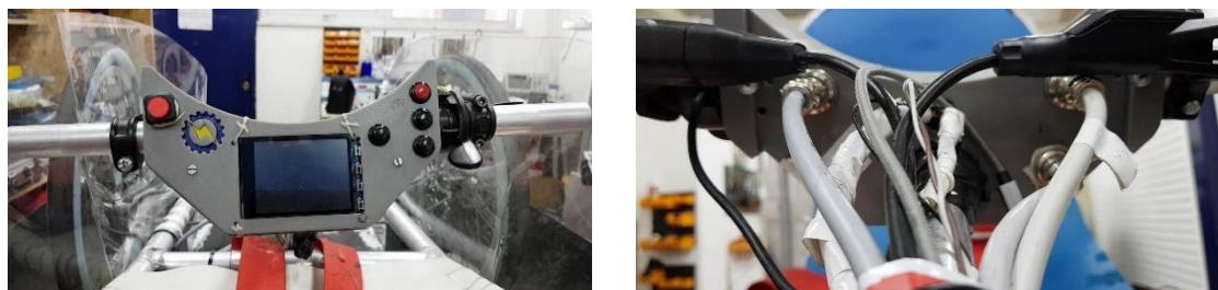
Εικόνα 7.7: Αριστερή εικόνα παρουσιάζει τη πρόσοψη του τιμονιού και η δεξιά το πίσω μέρος και όλα τα καλώδια των υποκυκλωμάτων που εισέρχονται σε αυτό μέσω βυσμάτων.
