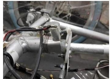
Εικόνα 7.6: Αριστερά φαίνεται το ποτενσιόμετρο που χρησιμοποιήθηκε και οι άλλες δύο εικόνες παρουσιάζουν τη βάση στήριξης του.
