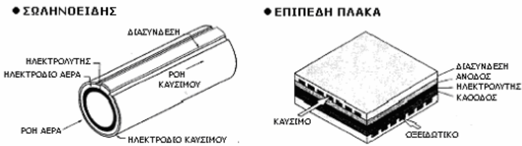
Σχέδια κυψελών καυσίμων SOFC στην κάθοδο
