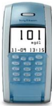
Σχήμα 5.4 Εμφάνιση αποτελεσμάτων στην οθόνη του P800
