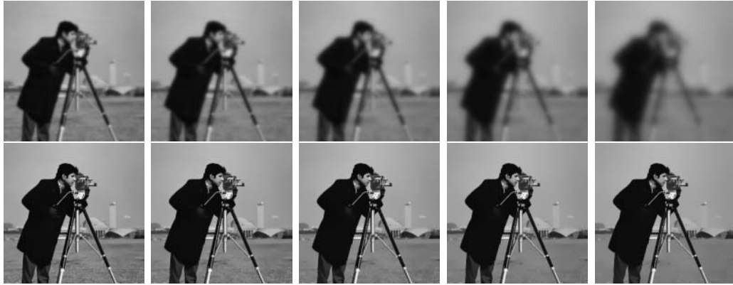
Σχήμα 1.2: Χώροι κλίμακας από διάχυση για την εικόνα “Cameraman.” (256×256 pixels, 256 στάθμες γκριζου), που παράχθηκαν σε δύο επαναλήψεις με τους αλγορίθμους του κεφαλαίου 4. Κλίμακες (από αριστερά προς τα δεξιά) 4, 8, 16, 32, 64. Πάνω: Gaussian χώρος κλίμακας. Κάτω: ανισοτροπικός χώρος κλίμακας (παράμετρος \sigma της εξίσωσης (1.4) ίση με 0.01).
