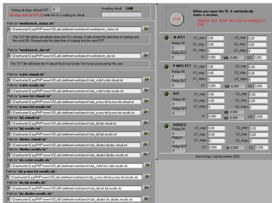
Σχήμα 3.11 Workbench.vi : To Front panel
