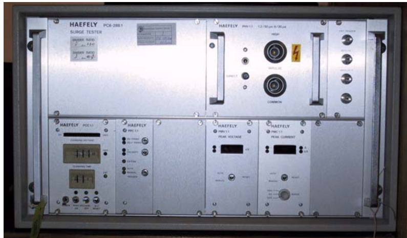
Εικόνα 5.4: Γεννήτρια ASEA-HAEFELY Type PC 6-288
