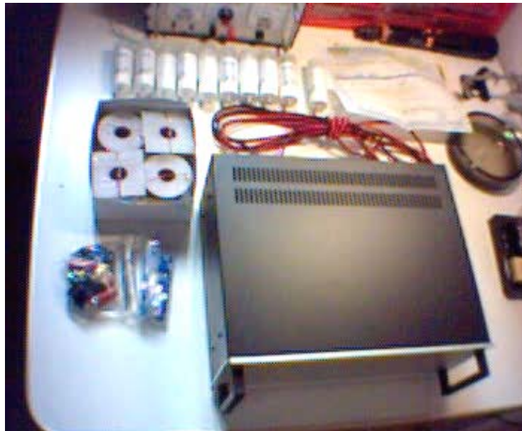
Εικόνα 4.2: Τα απαιτούμενα για την κατασκευή υλικά μετά την αγορά τους στον εργαστηριακό πάγκό. Διακρίνονται, εκτός από το κουτί, τα πηνία και οι πυκνωτές. Στα σακουλάκια βρίσκονται οι μπόρνες και τα κώξ (συρταρωτά και στρογγυλά).
