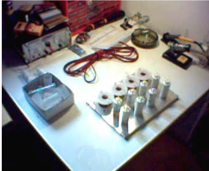
Εικόνα 4.8: Τοποθέτηση των πυκνωτών στο σασί.
