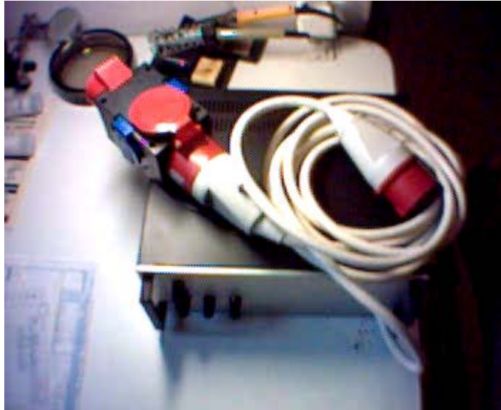
Εικόνα 4.12: Η συσκευή έτοιμη. Διακρίνονται τα ογκώδη τριφασικά φισ. Επίσης διακρίνεται ο ογκώδης αντάπτορας στην έξοδο της συσκευής που δίνει την δυνατότητα σύνδεσης ενός τριφασικού φορτίου και δύο μονοφασικών φορτίων στις L1, L3.
