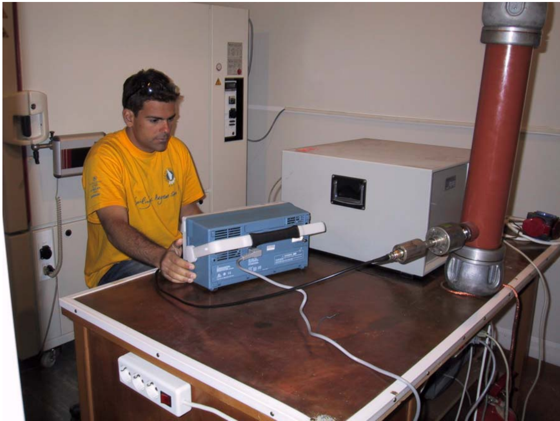
Εικόνα 5.19: Φωτογραφία της διάταξης δοκιμής με την κρουστική γεννήτρια. Εύκολα κανείς παρατηρεί τον ογκώδη καταμεριστή τάσης.
