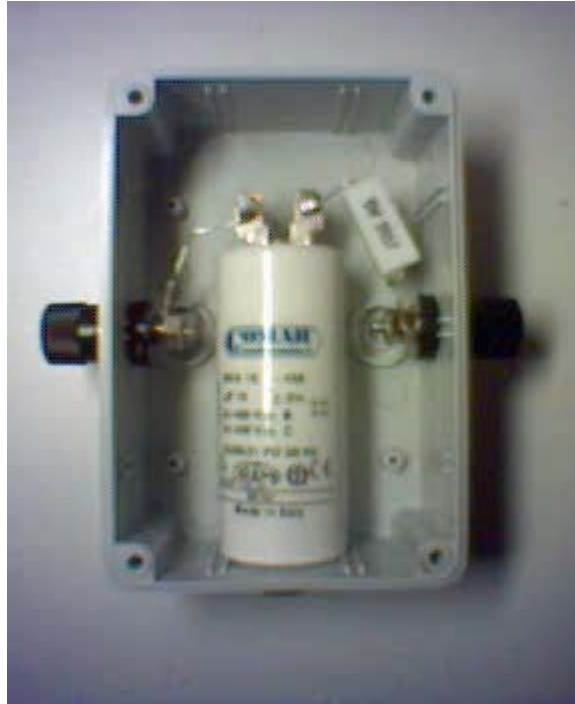
Εικόνα 4.16: Ο προσαρμογέας έτοιμος λίγο πριν κλείσει το καπάκι. Έχουν τοποθετηθεί οι μπόρνες και έχουν γίνει όλες οι απαραίτητες κολλήσεις.
