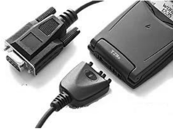
Εικόνα 2.3 Σύνδεση τηλεφώνου με το καλώδιο δεδομένων
