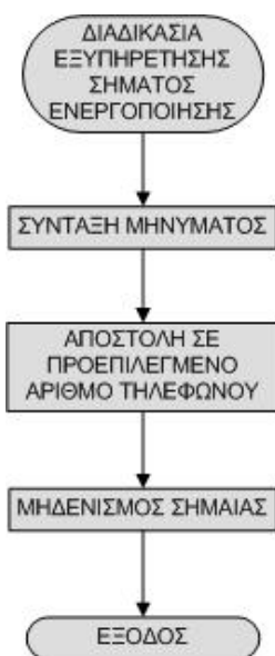
Σχήμα 5.5 Block διάγραμμα της διαδικασίας εξυπηρέτησης σήματος ενεργοποίησης
