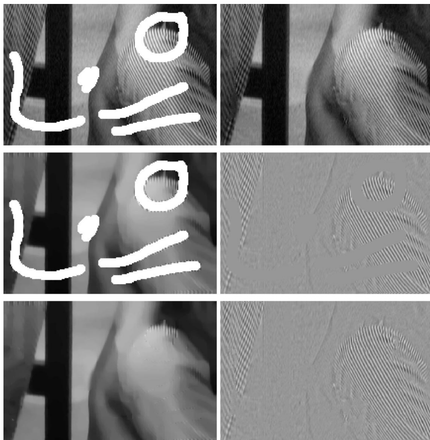
Σχήμα 3.19: Παράδειγμα Inpainting περιεχομένου και υφής: 1η γραμμή: Αρχική και τελική εικόνα, 2η γραμμή: Διαχωρισμός περιεχομένου και υφής, 3η γραμμή: Inpainting περιεχομένου και υφής. (Από το [39])
