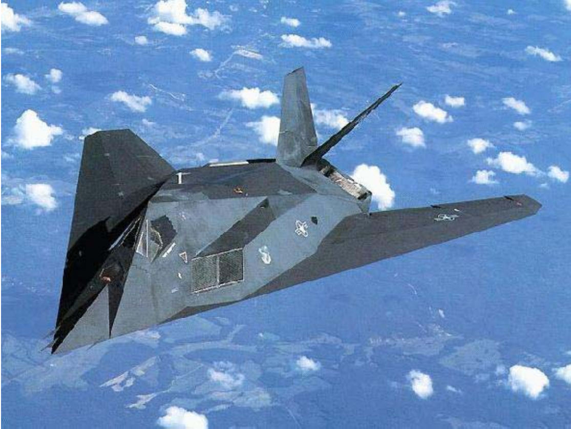
Σχήμα 3.9 : Βομβαρδιστικό αεροσκάφος F-117 (stealth) , φαίνονται τα έντονα κοψίματα που έχει.
