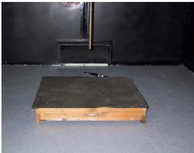
Εικόνα 5.5: Διάταξη ηλεκτροδίων ακίδας-πλάκας στο θάλαμο εκκενώσεων
