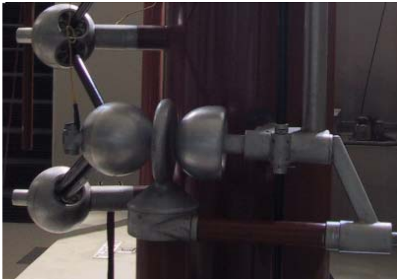
Εικόνα 5.3: Η πρώτη από τις οκτώ βαθμίδες της κρουστικής γεννήτριας, με το σπινθηριστή έναυσης
