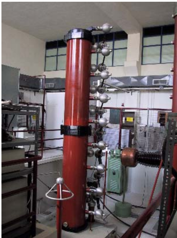
Εικόνα 5.1: Οκταβάθμια γεννήτρια κρουστικών τάσεων στο εργαστήριο κρουστικών τάσεων του Ε.Μ.Π.
