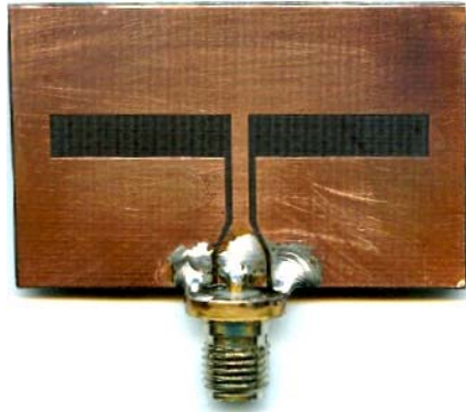
Σχήμα 5.14 Ορθογωνική σχισμοκεραία με transition
