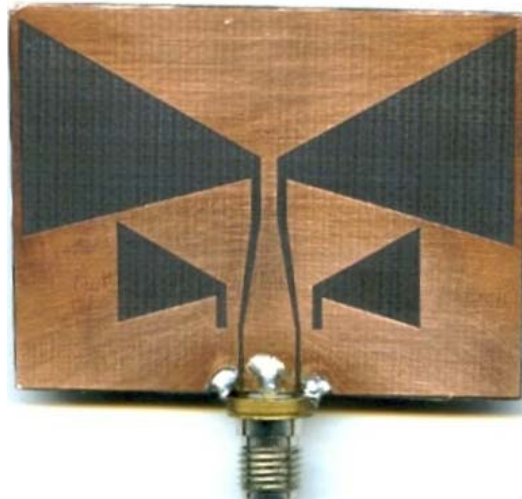
Σχήμα 5.46 bow-tie κεραία με παρασιτικά στοιχεία
