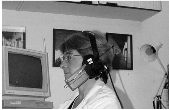
εικόνα 2.4 Το σύστημα έκθεσης των εθελοντών στην ακτινοβολία. Φαίνεται πως ένα μοντέλο κινητού είναι προσαρμοσμένο στο κεφάλι ενός εθελοντή και πως λαμβάνονται οι μετρήσεις.
