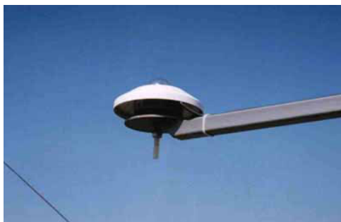
Εικόνα 5-1 Το πυρανόμετρο με το οποίο έγιναν οι μετρήσεις της ηλιακής ακτινοβολίας
