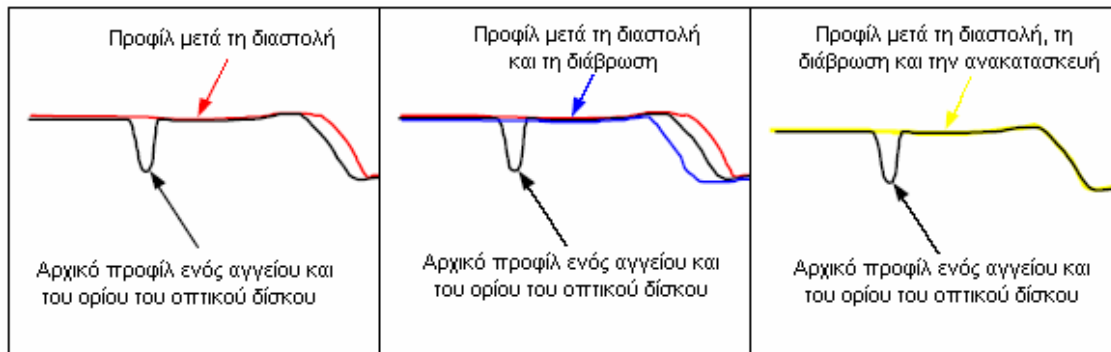
Σχ. 4.3 : Αναπαράσταση των τριών σταδίων του μορφολογικού φιλτραρίσματος που χρησιμοποιούνται για την προεπεξεργασία της εικόνας.
